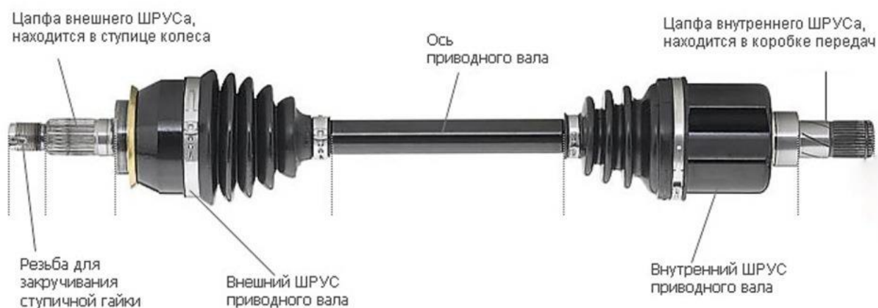
Рисунок А2 – Конструкция автомобильного ШРУСа
